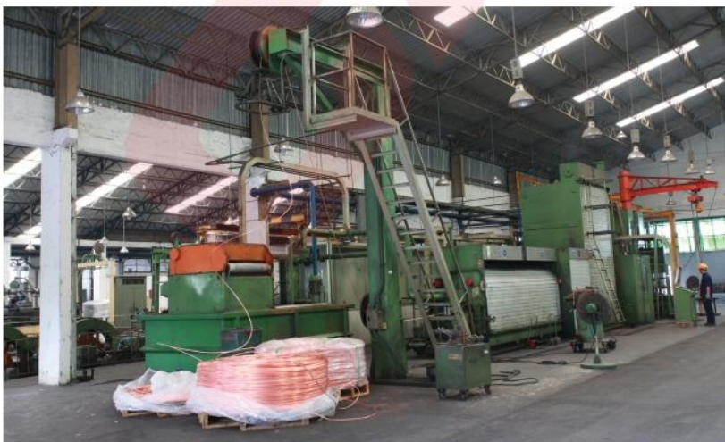
Máy kéo ủ đồng liên tục Henrich (Đức) Henrich rod breakdown drawing machine with annealing of Germany
